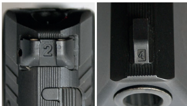
Fot. 22. Oznaczenia metalowych przyrządów celowniczych w pistolecie P-99
