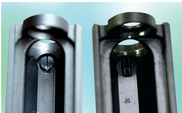
Fot. 19. Sposób montażu muszki w pistolecie P-99. Z lewej strony muszka metalowa, z prawej plastikowa
