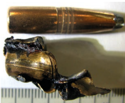
Fot. 9. Porównanie fragmentu dowodowego pocisku z pociskiem naboju zabezpieczonego w magazynku dowodowego sztucera
