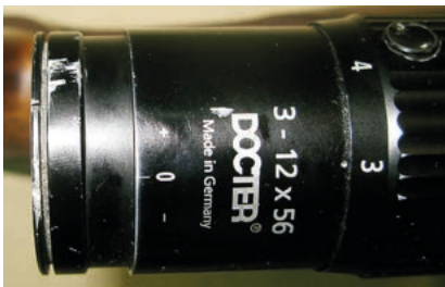
Fot. 8. Otarcia ujawnione na powierzchni cełownika optycznego dowodowego sztucera
