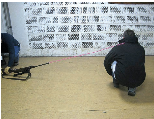
Fot. 10 do 14. Dokumentacja z przeprowadzanych badań przy użyciu sondy balistycznej
