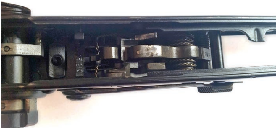
AKMS – mechanizm spustowy
