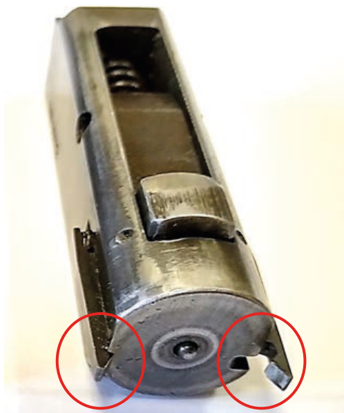
Fot. 159. Zamek z zaznaczonymi pazurami wyciągu
