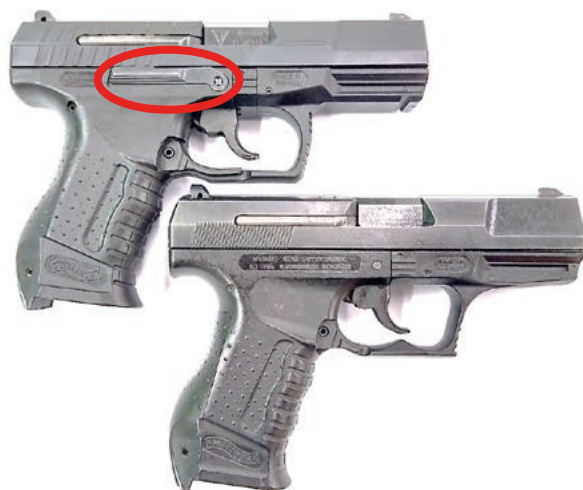
Fot. 48. Dźwignia zwalniania zamka (zaznaczona), u góry nowsza wersja P99, u dołu starsza – dźwignie zatrasku magazynka – w obu wersjach znajdują się po obu stronach kabłąka lecz w nowszej, zostały one wydłużone co ułatwia strzelcowi wypięcie magazynka,
