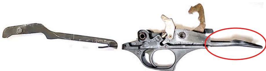
Fot. 200. Z lewej strony podajnik ze strzelby Mossberg 500A, z prawej podajnik (zaznaczony) ze strzelb Hatsan Escort i Super XS zespolony z mechanizmem spustowo-uderzeniowym
