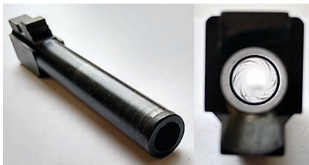
Fot. 31. Lufa poligonalna z widokiem od strony komory nabojeowej
