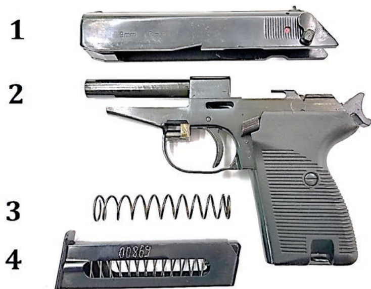
Fot. 20. Rozłożony pistolet P-83
