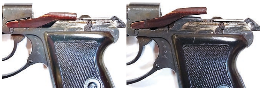
Fot. 14. Wyrzutnik pistoletu P-64 – z prawej strony uniesiony przez donośnik magazynka
