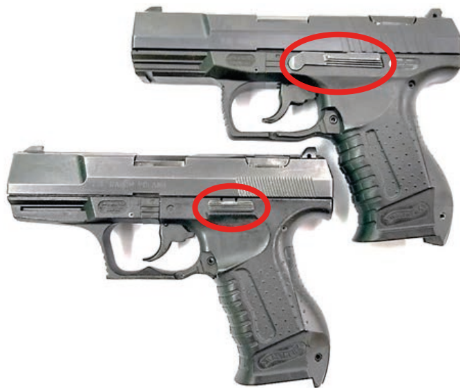
Fot. 47. Dźwignie zwalniania zamka (zaznaczone), u góry nowsza wersja P99, u dołu starsza
