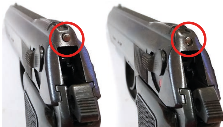
Fot. 16. Wskaźnik obecności naboju w P-64, z wprowadzonym nabojem (lewa strona) i bez wprowadzonego naboju (prawa strona)
