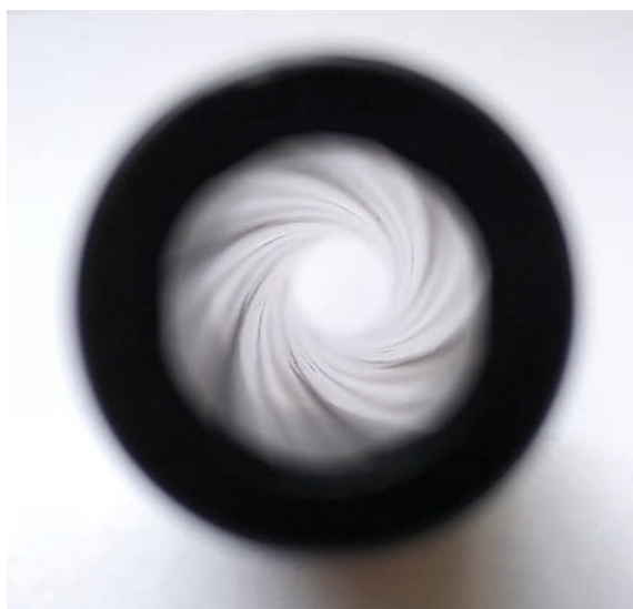
Fot. 32. Lufa poligonalna, widok od strony wylotu lufy
