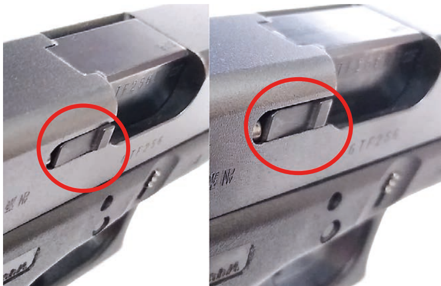
Fot. 34. Wskaźnik obecności naboju w komorze naboju, lewa strona komora załadowana z prawej niezaladowana
