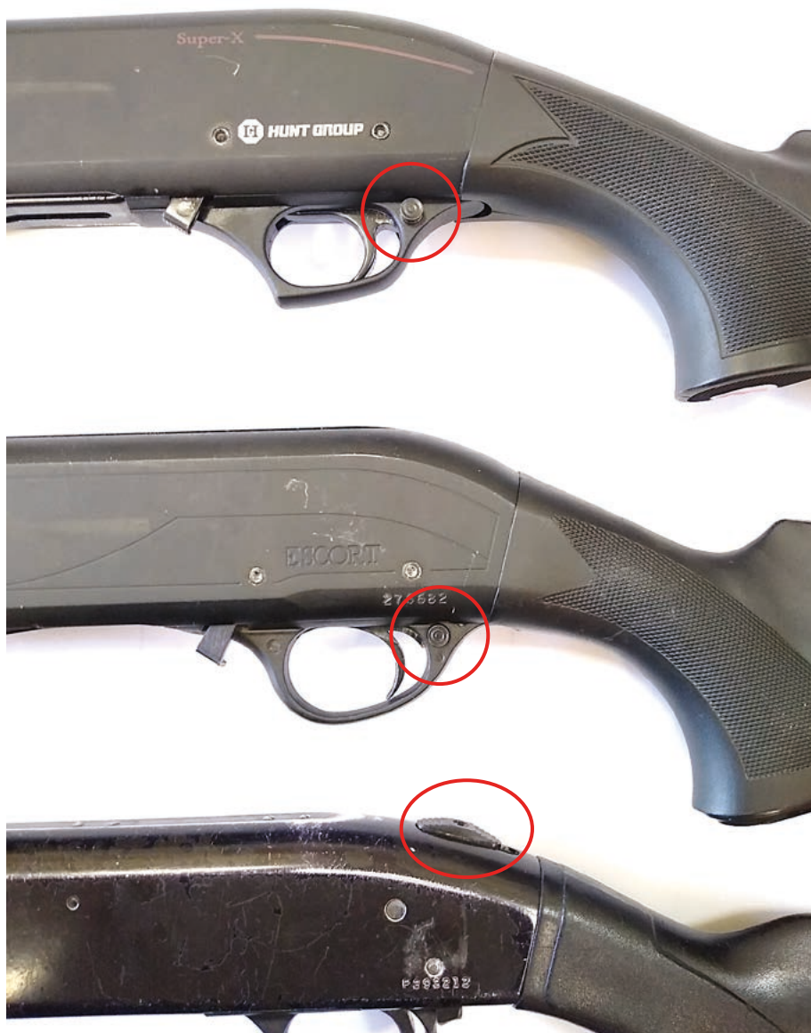
Fot. 193. Zaznaczone bezpieczniki, od góry Super XS, Hatsan Escort i Mossberg 500A
