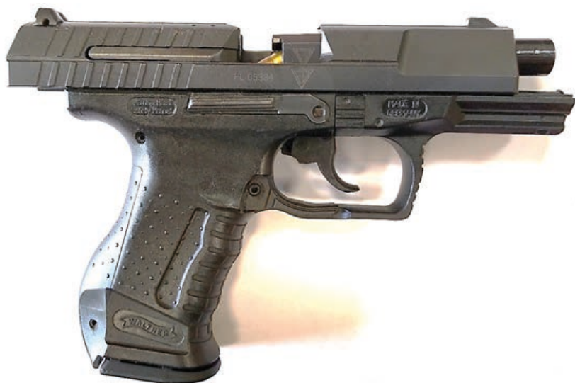
Fot. 106. Widok pistoletu P99, w którym wystąpiło zacięcie w postaci przekoszenia (utknięcia) naboju
