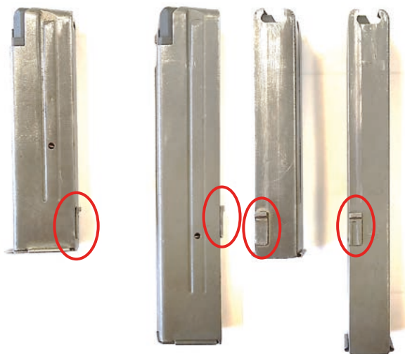
Fot. 122. Magazyneki do PM-84P i PM-84PP z zaznaczonymi nadlewami zatrzasku magazynka
