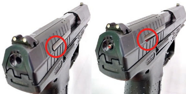
Fot. 42. Wskaźnik obecności naboju w komorze naboju, niezaladowana (lewa strona), zaladowana (prawa strona)
