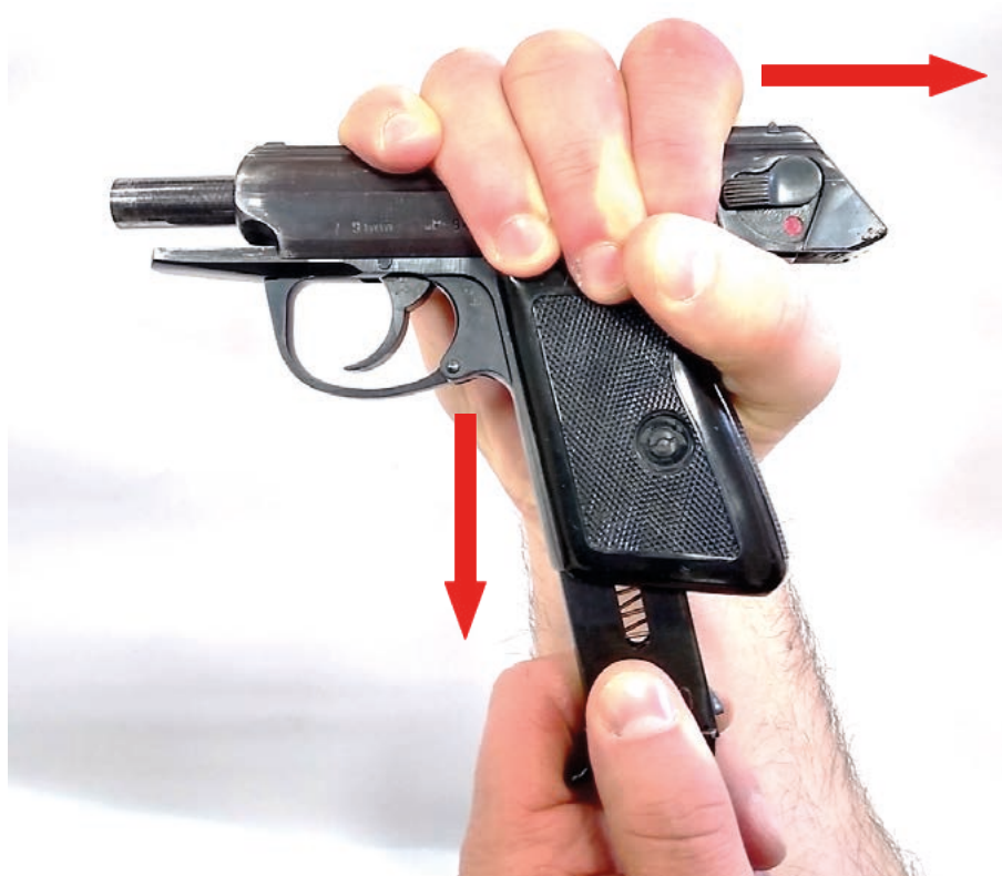
Fot. 116. Sposób usunięcia zablokowania broni nie wyposażonej w dźwignię zatrzymania (zwalniania) zamka
