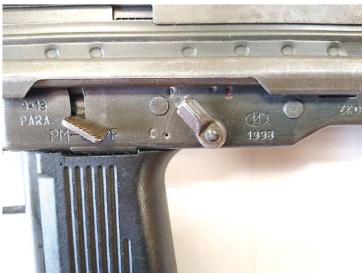
Fot. 125. Bezpiecznik w położeniu środkowym – ogień pojedynczy
