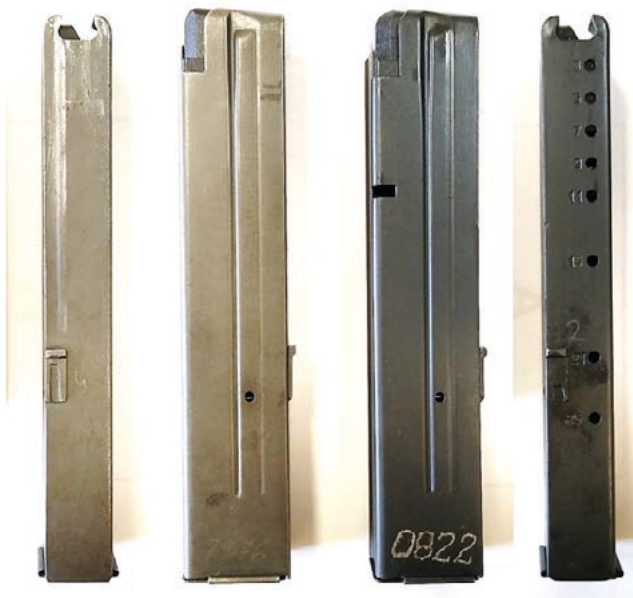
Fot. 124. Porównanie magazynków starego typu (lewa strona) i nowego typu (prawa strona)
