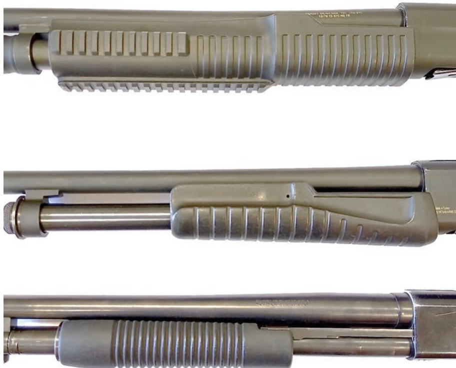
Fot. 201. Od góry rękojeści przeładowania strzelb: Super XS (jako jedyna posiada szyny montażowe), Hatsan Escort i Mossberg 500A
