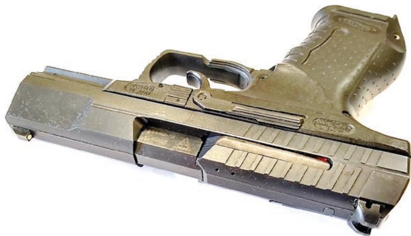
Fot. 101. Pistolet P99, w którym wystąpiło zacięcie w postaci niewypału, widok na komorę naboju i wskaźnik obecności naboju
