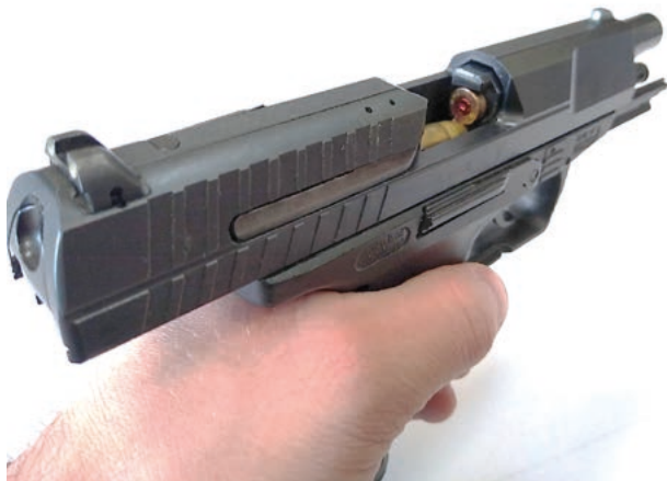
Fot. 113. Zablokowany pistolet P99, w oknie wyrzutowym zamka widnieją dwa zablokowane względem siebie naboje
