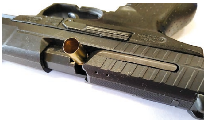
Fot. 110. Pistolet P99, w którym wystąpiło zacięcie w postaci przytrzaśnięcia (zakleszczenia) łuski, widoczna zakleszczona łuska w oknie wyrzutowym zamka
