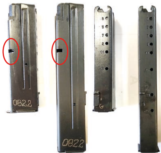
Fot. 123. Magazyneki do PM-98 i PM-98M z zaznaczonymi otworami zatrzasku magazynka. Posiadają również nadlewy umożliwiające użycie ich w starszych wersjach PM-84P i PP
