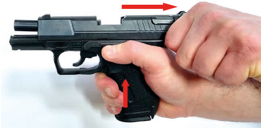
Fot. 115. Sposób usunięcia zablokowania broni poprzez zatrzymanie zamka broni w tylnym położeniu za pomocą dźwigni zatrzymania (zwalniania)
