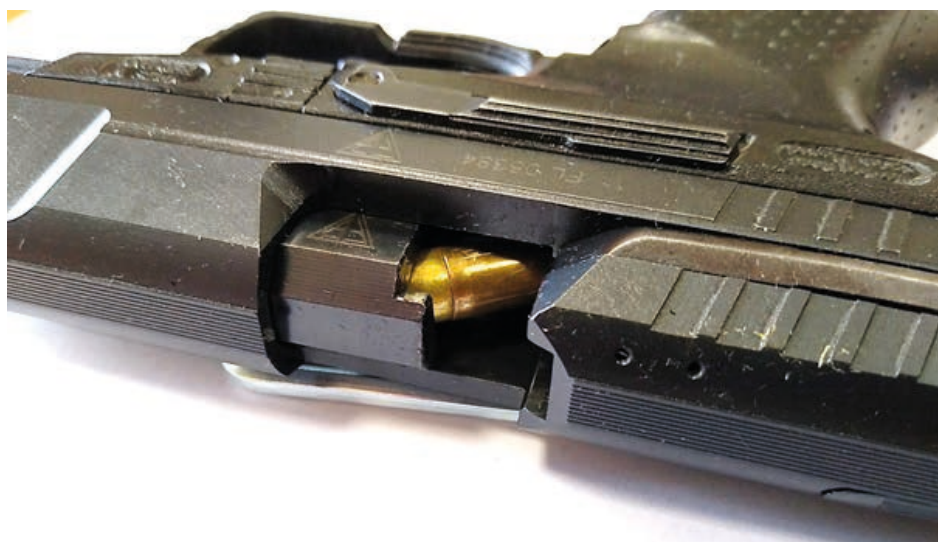
Fot. 107. Pistolet P99, w którym wystąpiło zacięcie w postaci przekoszenia (utknięcia) naboju, widoczny skośnie zablokowany nabój w oknie wyrzutowym zamka
