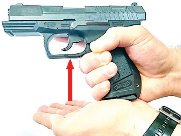
Fot. 112. Alternatywny sposób usuwania zacięć poprzez uderzenie w magazynek
