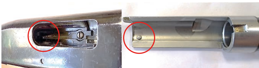
Fot. 199. Z lewej wyrzutnik w strzelbie Mossberg 500A, z prawej wyrzutnik w strzelbach Hatsan Escort i Super XS
