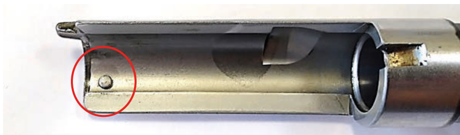
Fot. 181. Osada lufy z zaznaczonym wyrzutnikiem
