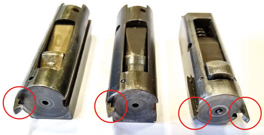
Fot. 196. Zaznaczone pazury wyciągu łuski lub naboju, od lewej zamki ze strzelb: Super XS, Hatsan Escort i Mossberg 500A
