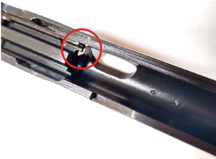
Fot. 13. Pazur wyciągu w P-64 (zaznaczony)
