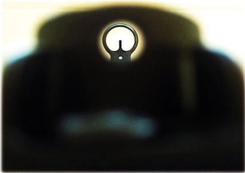
Fot. 128. Przyrządy celownicze zamknięte (na przykładzie HK MP5)
