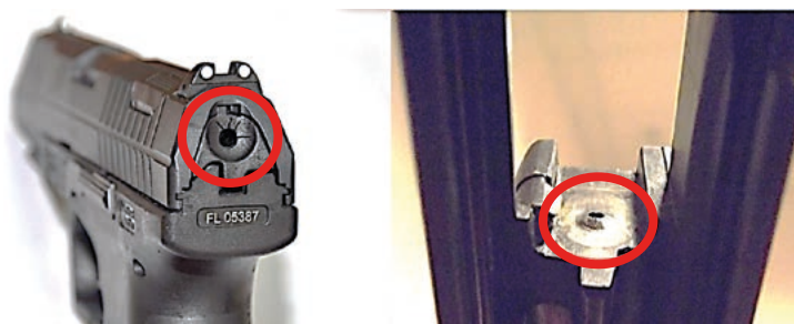
Fot. 54. Z lewej strony widoczne pęknięcia płytki oporowej iglicy, z prawej uszkodzenie czółka zamka
