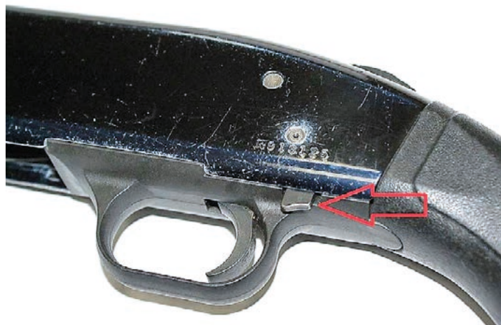
Fot. 155. Zatrzask suwadła
