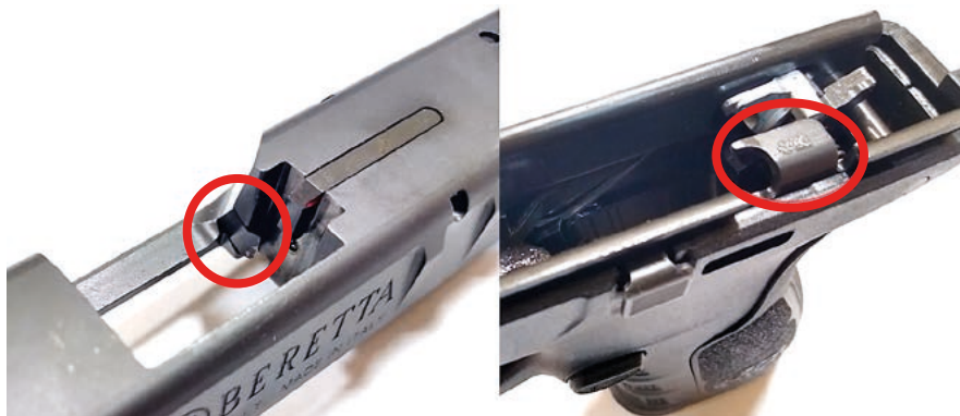
Fot. 67. Zaznaczony pazur wyciągu (lewa strona) oraz wyrzutnik łuski lub naboju (prawa strona)
