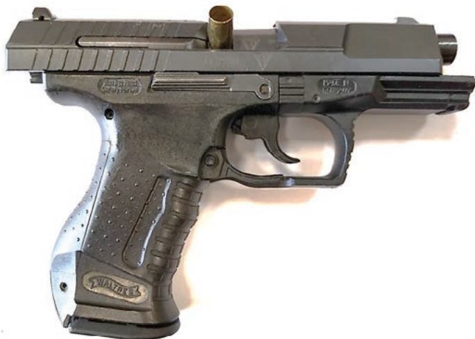
Fot. 109. Widok pistoletu P99, w którym wystąpiło zacięcie w postaci przytrzaśnięcia (zakleszczenia) łuski
