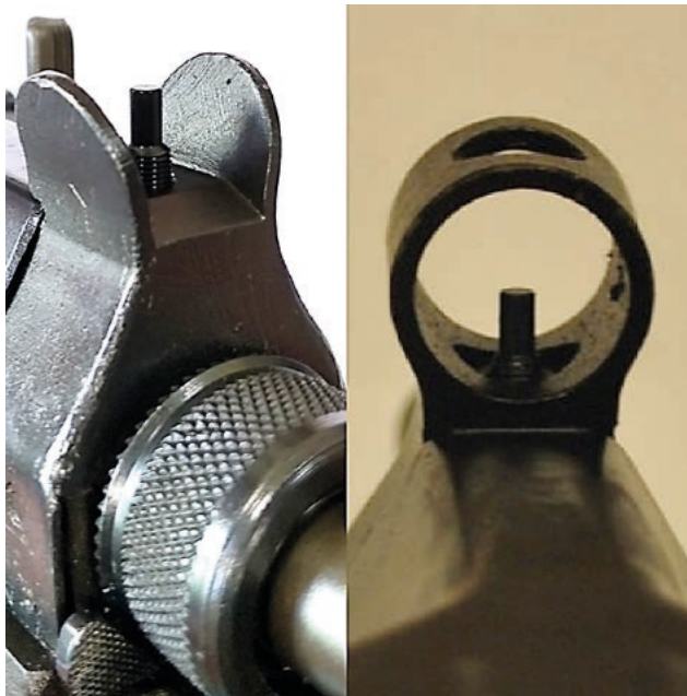
Fot. 127. Muszka wraz z osłoną (lewa strona), tunelowa osłona muszki zastosowana w PM-98M (prawa strona)
