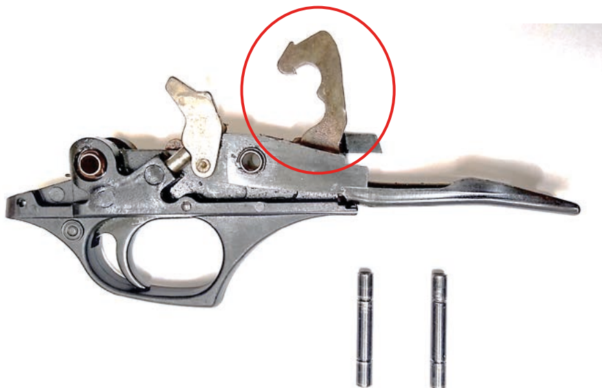
Fot. 180. Mechanizm spustowo-uderzeniowy ze zwolnionym kurkiem (zaznaczony) i sworzniami mocującymi
