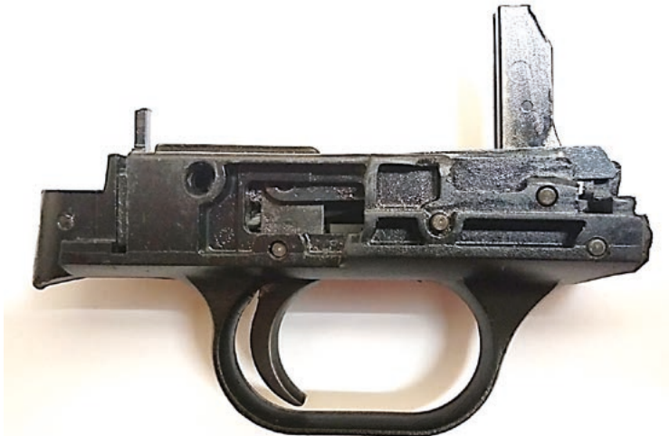
Fot. 157. Mechanizm spustowo-uderzeniowy z kurkiem w położeniu pośrednim
