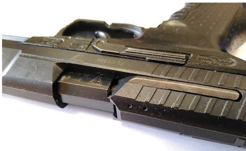
Fot. 103. Pistolet P99, w którym wystąpiło zacięcie w postaci niedomknięcia komory naboowej, widoczna kryza łuski w oknie wyrzutowym zamka
