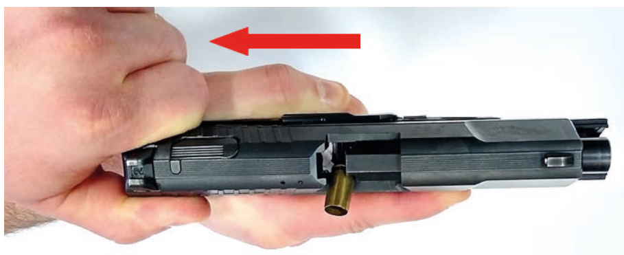
Fot. 111. Usunięcie zacięcia przytrzaśnięcia (zakleszczenia) łuski na przykładzie P99
