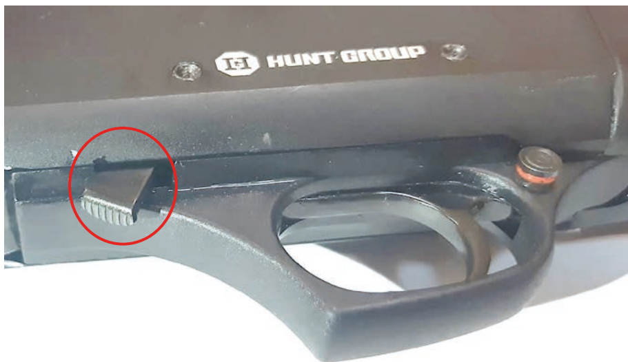
Fot. 179. Zatrzask suwadła (zaznaczony)
