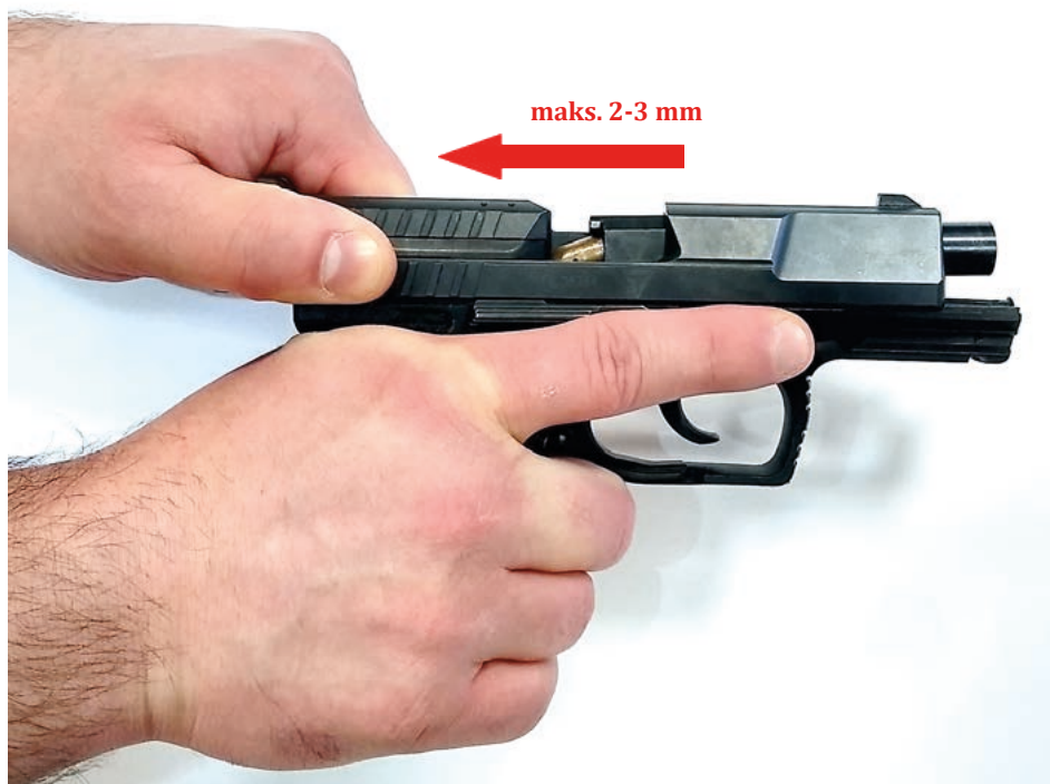
Fot. 108. Usunięcie zacięcia przekoszenia (utknięcia) naboju na przykładzie P99
