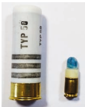
Fot. 6. Amunicja specjalna: TYP 50 kal. 12/70 (lewa strona) oraz barwiąca 9 mm FX (prawa strona)
