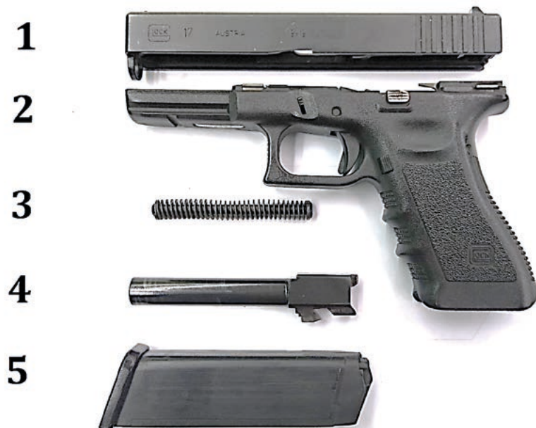
Fot. 27. Rozłożony pistolet GLOCK
