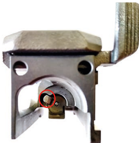
Fot. 131. Zamek z zaznaczonym pazurem wyciągu naboju lub łuski
