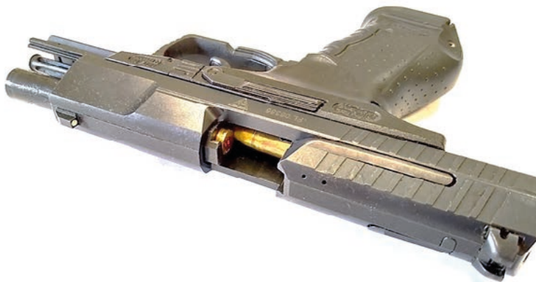
Fot. 114. Zablokowany pistolet P99, widok od okna wyrzutowego
