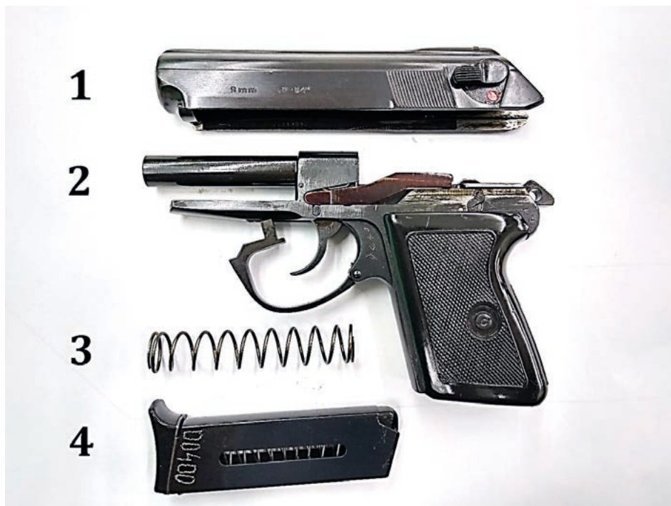
Fot. 12. Rozłożony pistolet P-64
