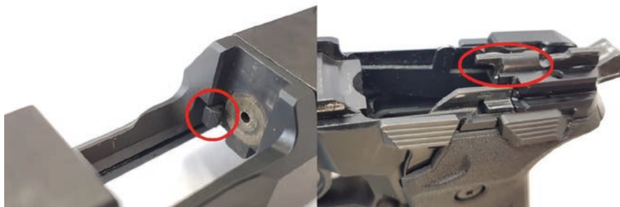
Fot. 57. Zaznaczony pazur wyciągu (lewa strona) oraz wyrzutnik łuski lub naboju (prawa strona)
