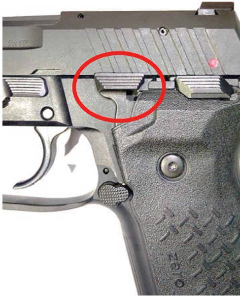
Fot. 64. Dźwignia zwalnicza kurka (zaznaczona)
