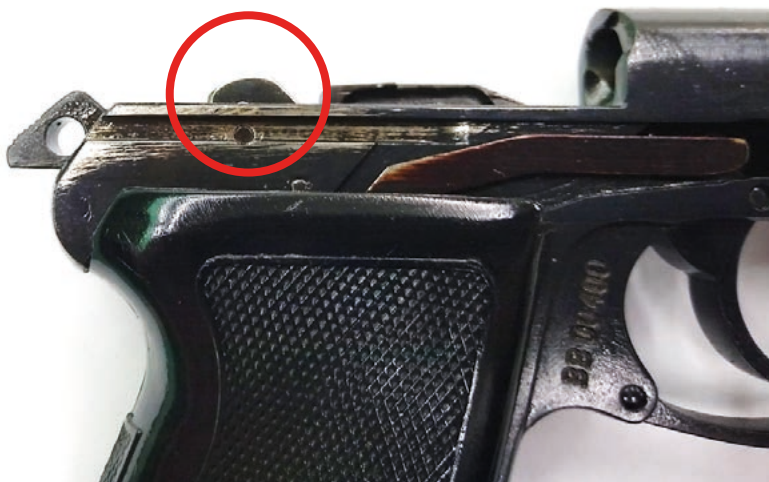
Fot. 17. Wyłącznik w pistolecie P-64 (zaznaczony)
