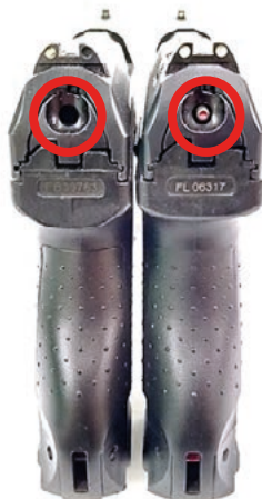
Fot. 41. Wskaźnik napięcia iglicy, zwolniona (lewa strona), napięta (prawa strona)
