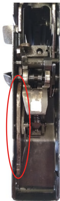
Fot. 130. Opóźniacz bezwładnikowy (zaznaczony)
