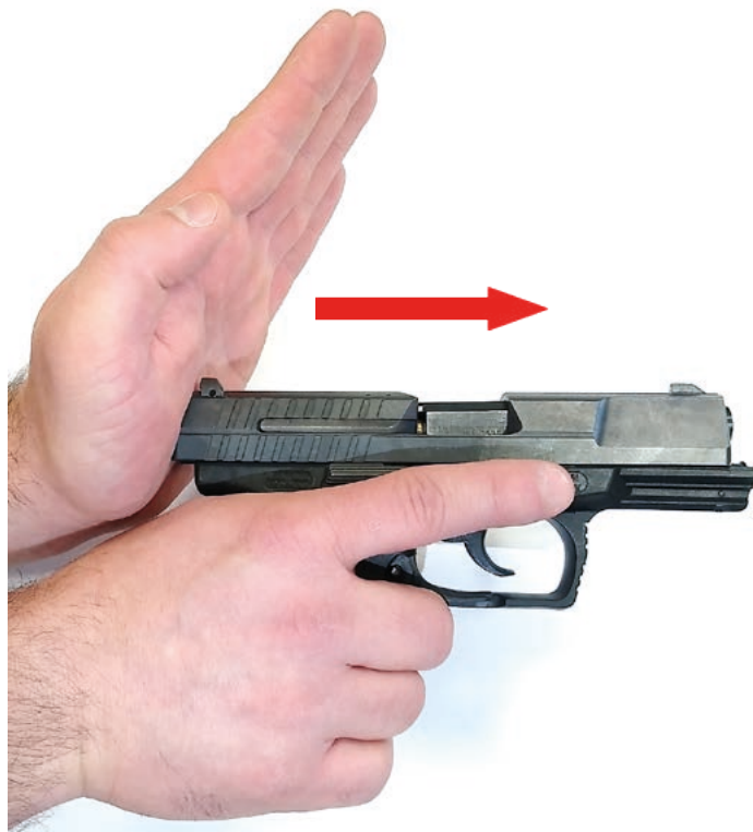
Fot. 104. Usunięcie zacięcia niedomknięcia komory nabojej w broni bezkurkowej na przykładzie P99
