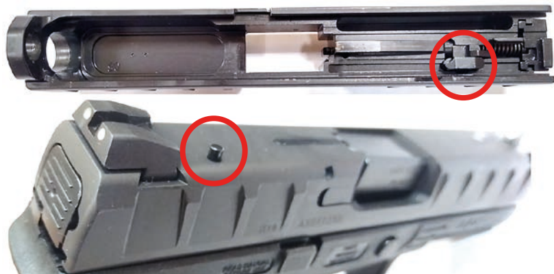
Fot. 70. Zaznaczona blokada iglicy, w trakcie ściągnięcia języka spustowego unosi się element blokady widoczny w dolnej części zdjęcia
