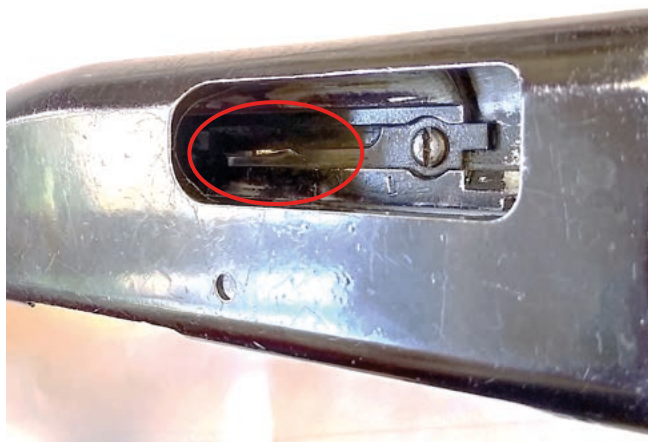
Fot. 158. Przez okno wyrzutowe widoczny wyrzutnik łuski lub naboju (zaznaczony)
