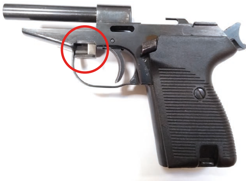
Fot. 23. Zderzak w pistolecie P-83 (zaznaczony)
