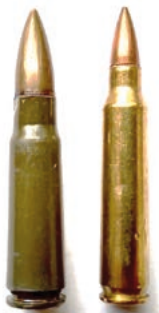
Fot. 3. Naboje pośrednie: 7,62x39 mm wz. 43 (lewa strona) oraz 5,56x45 mm (prawa strona)
