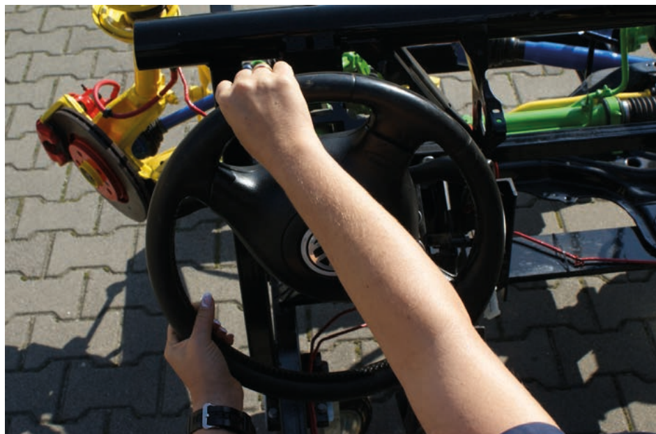
Fot. 22. Kontrola przekładni kierowniczej
