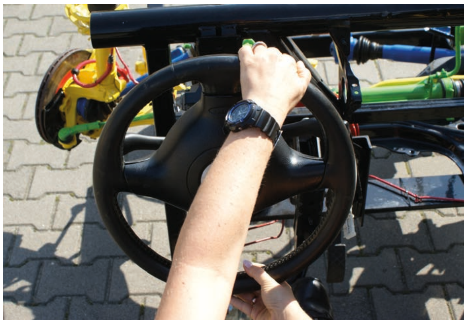
Fot. 31. Kontrola ogranicznika skrętu
