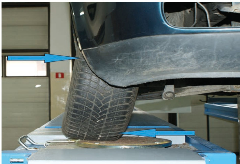
Fot. 43. Nieprawidłowe ustawienie kół – kąt pochylenia
