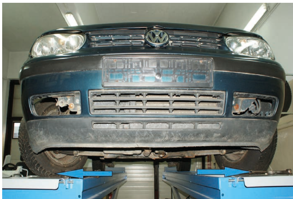
Fot. 42. Nieprawidłowe ustawienie kół – rozbieżność
