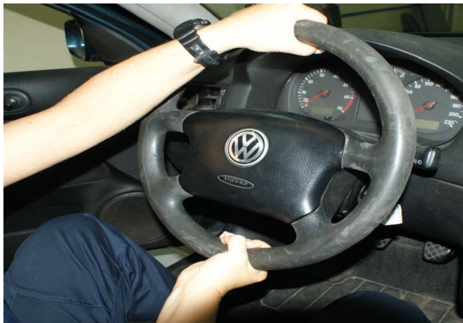
Fot. 36. Kontrola luzu promieniowego koła kierownicy
