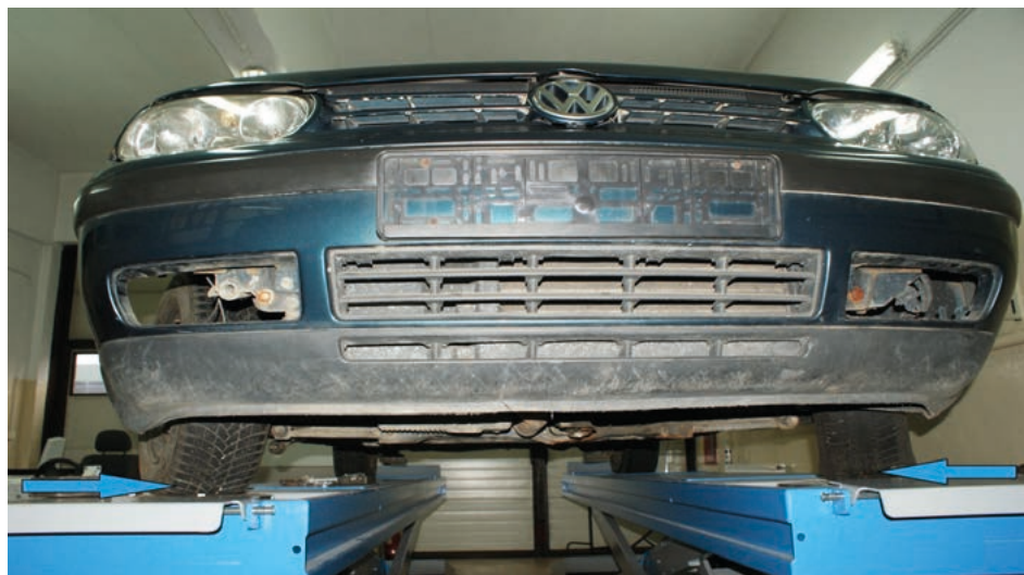
Fot. 41. Nieprawidłowe ustawienie kół – zbieżność
