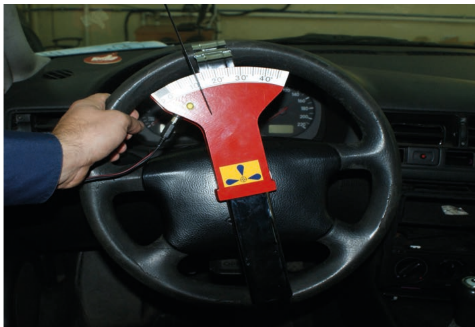
Fot. 40. Kontrola luzu sumarycznego za pomocą urządzenia LUZ 1
