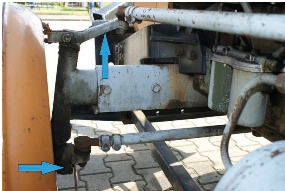
Fot. 20. Układ kierowniczy w zawieszeniu zależnym – dźwignia i ramię zwrotnicy wraz z drążkiem poprzecznym i podłużnym
