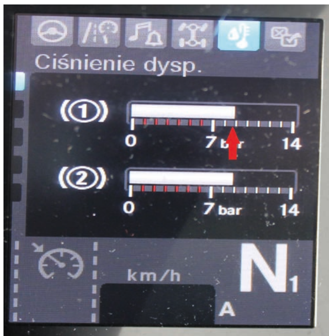
Fot. 25. Wskazanie przez manometr spadku ciśnienia na trzy pełne zahamowania
