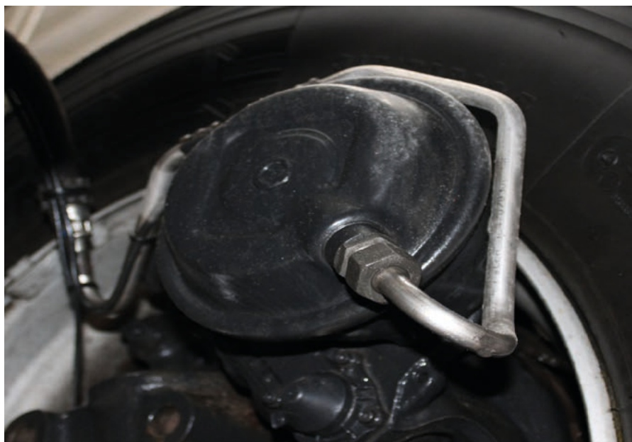
Fot. 7. Siłownik hamulca roboczego (zasadniczego)
