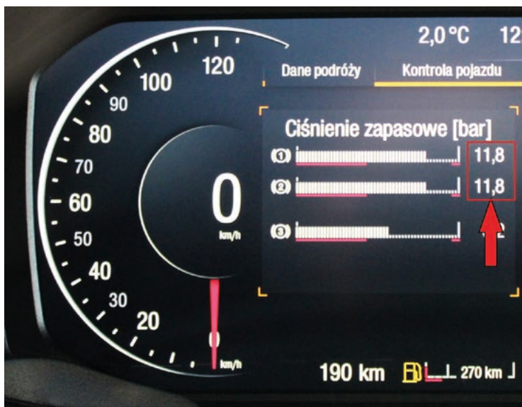
Fot. 21. Wskazanie przez manometr ciśnienia nominalnego
