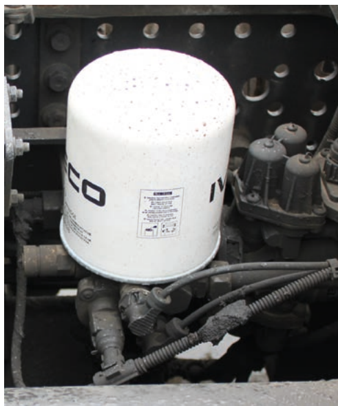
Fot. 14. Filtr mający za zadanie osuszenie, odwodnienie, odmrożenie i odolejenie
