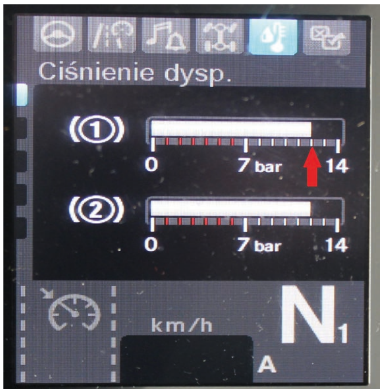
Fot. 23. Wskazanie przez manometr ciśnienia kontrolnego (pełna wartość 12 barów).
