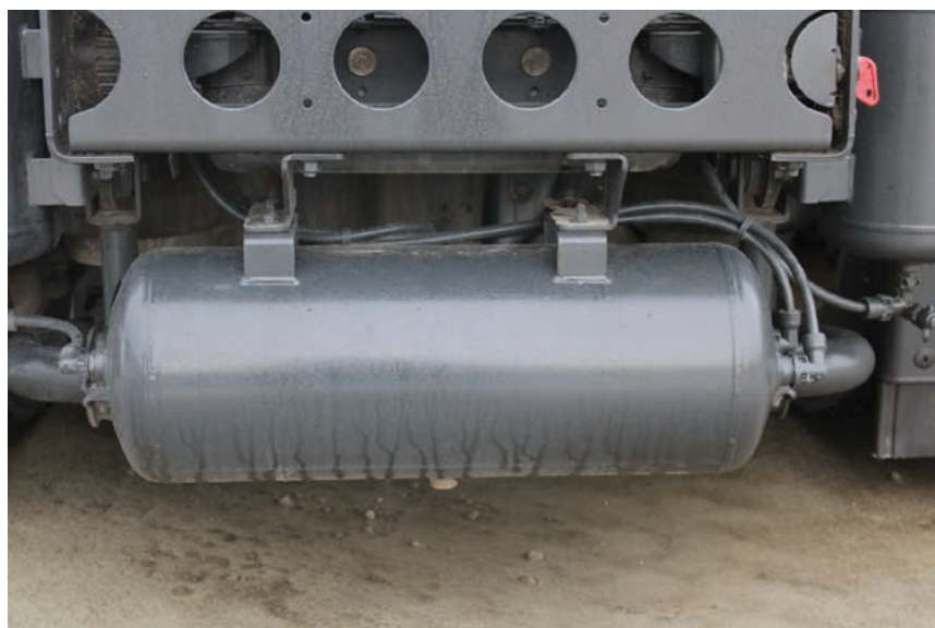
Fot. 4. Zbiornik sprężonego powietrza
