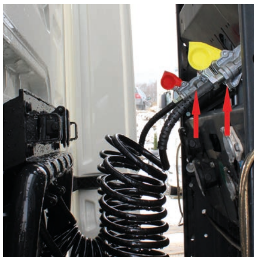
Fot. 9. Dodatkowe złącza hamulcowe (np. połączenie naczepy)
