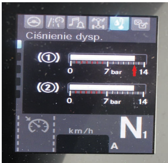
Fot. 22. Wskazanie przez manometr ciśnienia nominalnego
