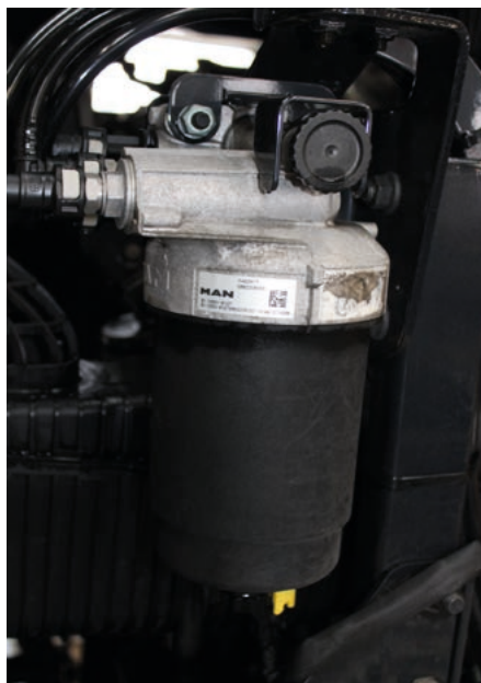
Fot. 13. Filtr mający za zadanie osuszenie, odwodnienie, odmrożenie i odolejenie
