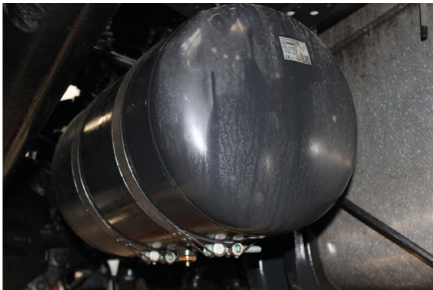
Fot. 3. Zbiornik sprężonego powietrza
