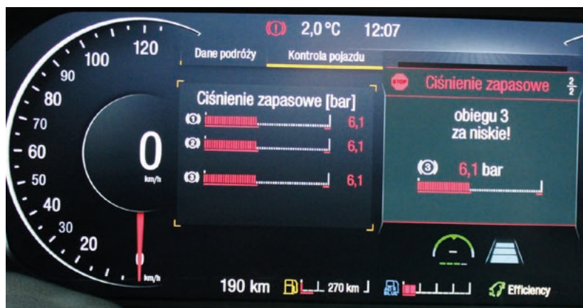
Fot. 26. Wskazanie przez manometr ciśnienia awaryjnego
