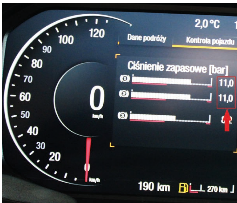
Fot. 22. Wskazanie przez manometr ciśnienia kontrolnego (pełna wartość 11,0 barów)
