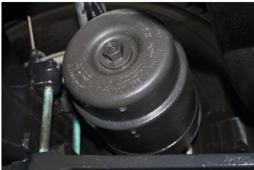
Fot. 6. Siłownik hamulca roboczego (zasadniczego) oraz postojowego
