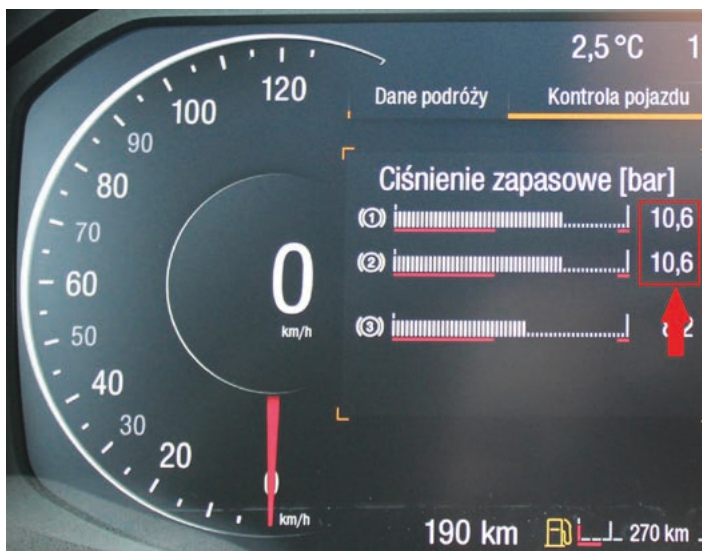
Fot. 24. Wskazanie przez manometr spadku ciśnienia na jedno pełne zahamowanie
