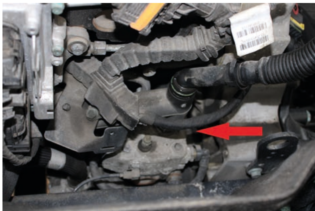
Fot. 1. Sprężarka samochodu ciężarowego marki Man
