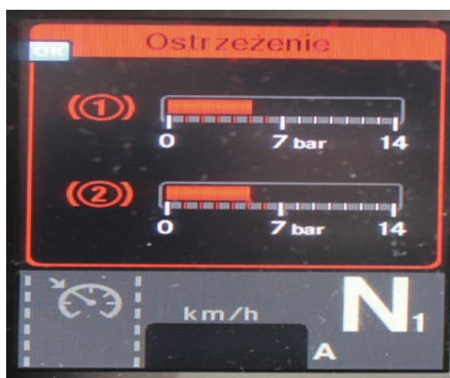
Fot. 27. Wskazanie przez manometr ciśnienia awaryjnego
